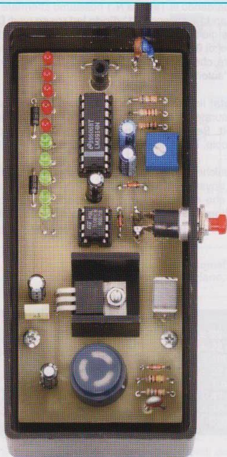
Fig.6 Dopo aver avvitato il circuito stampato al mobile con le due viti autofilettanti che troverete al suo interno, potrete collegare il pulsante P1 al circuito saldando ai due capicorda, che avrete in precedenza inserito sullo stampato, i suoi terminali.
