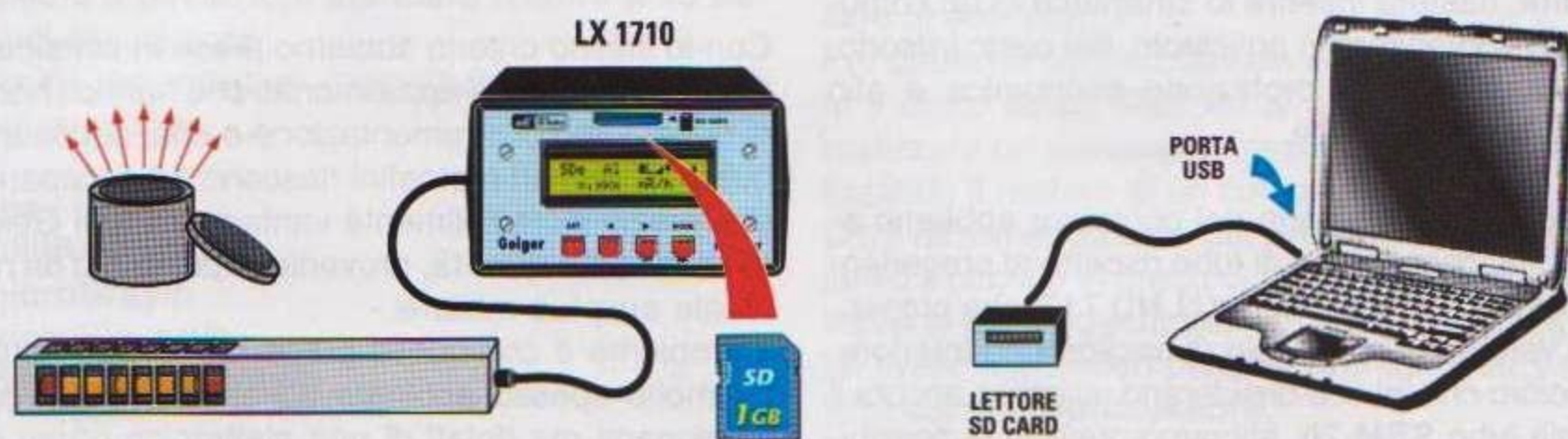
Fig.3 Inserendo nel contatore una SD card da 1 Gbyte avrete la possibilità di registrare un numero enorme di dati, eseguendo rilevamenti accurati della radioattività ambientale su un arco anche molto prolungato di tempo. I dati raccolti potranno essere successivamente elaborati tramite un personal computer, inserendo la SD card nell'apposito Card reader, collegato alla porta USB del pc.
