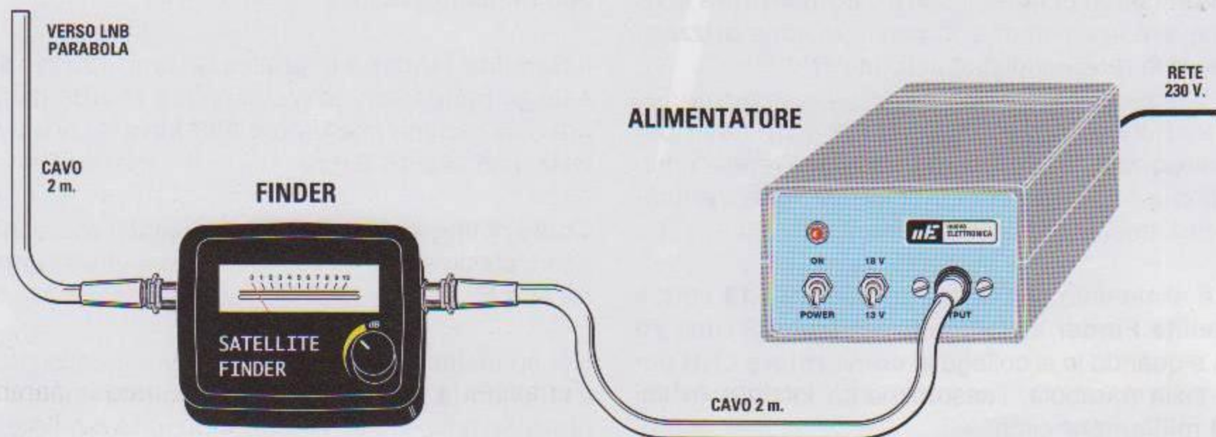
Fig.3 Dopo aver collegato il Satellite Finder al convertitore LNB posto sulla parabola e allo stadio di alimentazione visibile in fig.7, ruotate la manopola del Guadagno fino a portare la lancetta dello strumento sul numero 2. A questo punto iniziate a cercare il satellite desiderato muovendo la parabola in modo "micrometrico" sia in senso verticale che orizzontale. Quando la parabola risulta centrata sul satellite udrete una nota acustica e vedrete la lancetta dello strumento deviare verso il fondo scala.
